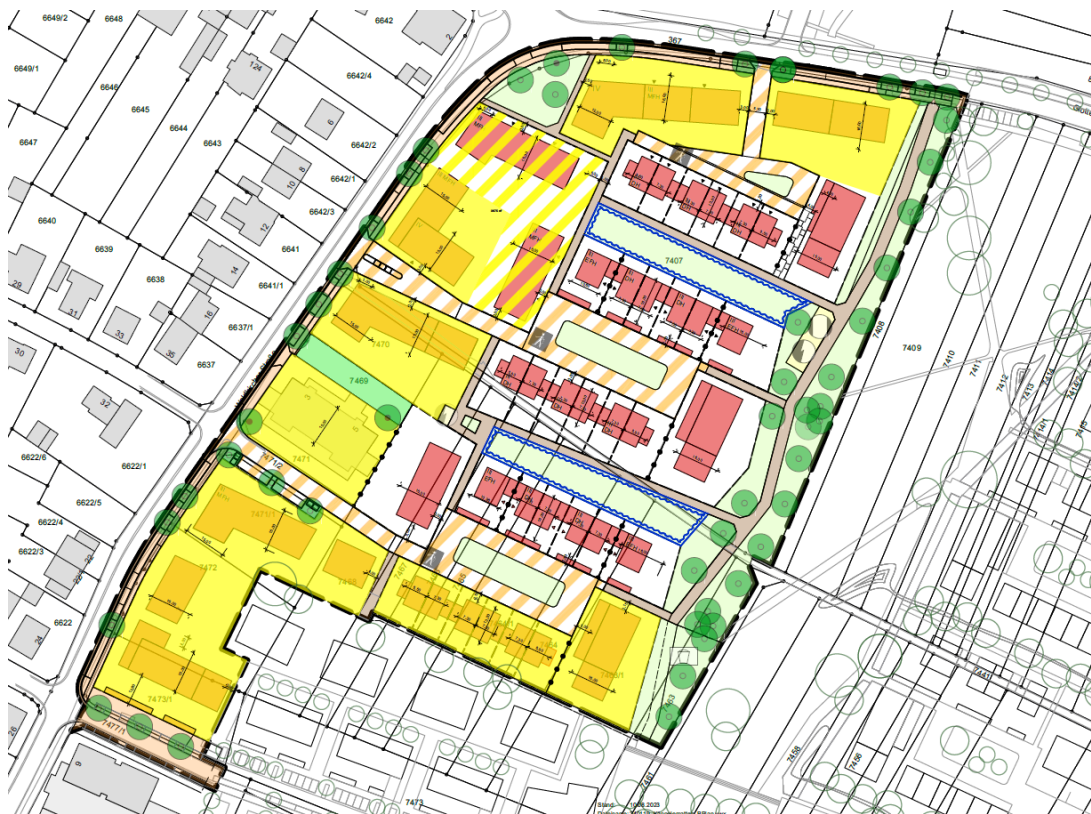
Abbildung – Zuordnung der Festsetzungen zur Entwässerung: gelb = Versickerung auf den Grundstücken, weiß = Einleitung in zentrale Versickerungsflächen, gelb-weiß gestreift: zentrale und dezentrale Versickerung möglich, unmaßstäblich
